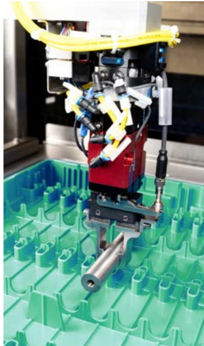
Funktions- und Machbarkeitstest mit Blindmustern
